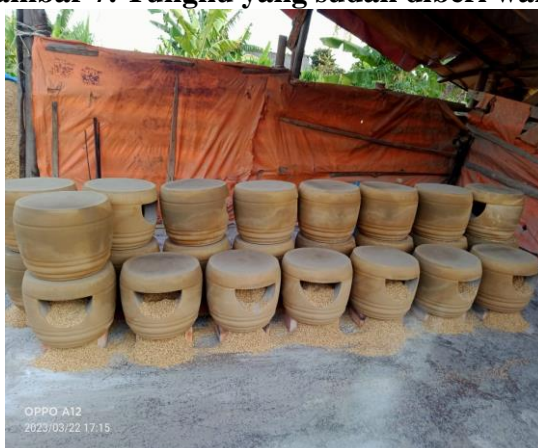
Gambar 8. Proses penumpukan tungku sebelum dibakar
