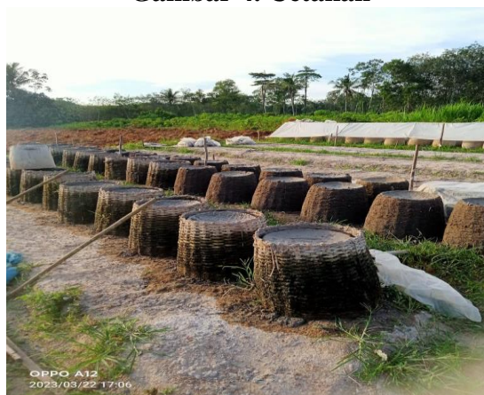
Gambar 5. Tungku yang masih dalam cetakan
